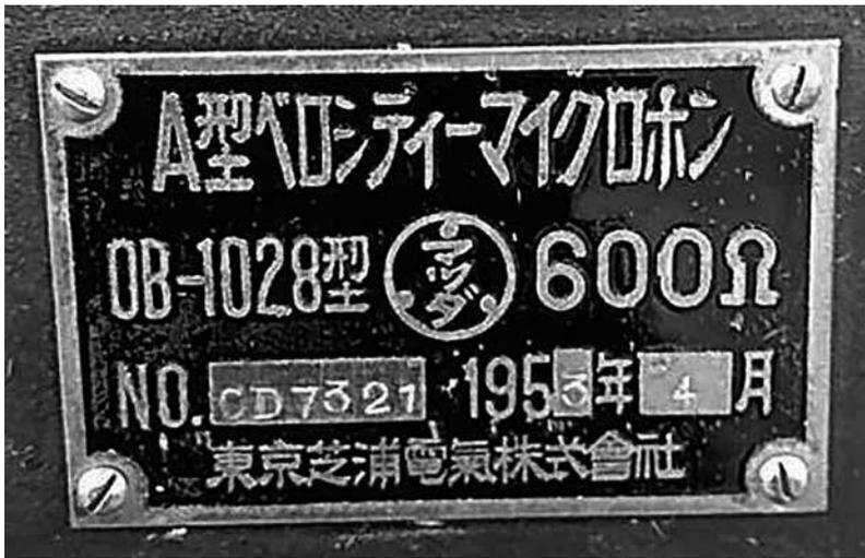
【図 2-17】 A 型ベロシティーマイクロホン 銘板 製造時期により、東京電気無線／東京電気／東京芝浦電気の 3 種ある。
